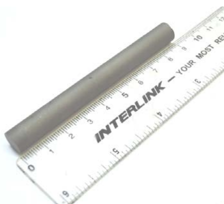
Рис. 2. Контрольный образец из титана марки Ti-6Al-4V
