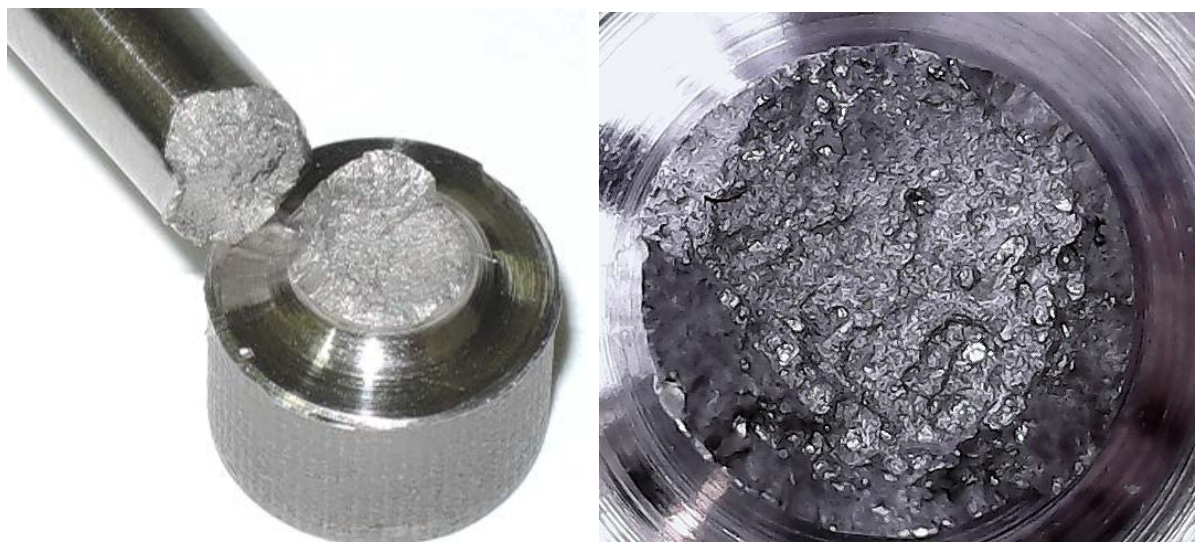
Рис. 12. Разрушение контрольного образца после испытаний и увеличенное изображение места разрыва
