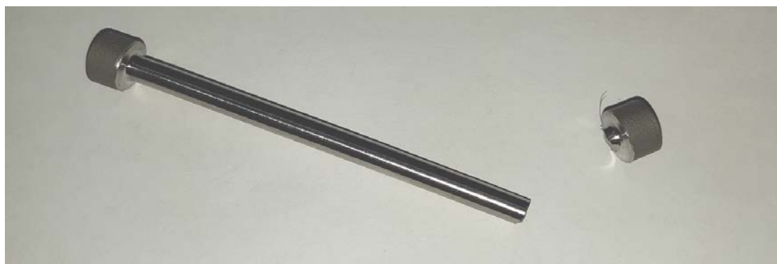
Рис. 11. Контрольный образец после испытаний методом разрушающего воздействия
