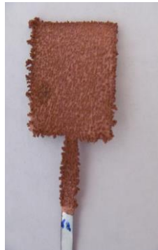
Рис. 2. Фотографии покрытия «медь-графен», полученных методом электрохимического осаждения при импульсном режиме осаждения (образец № 6).
