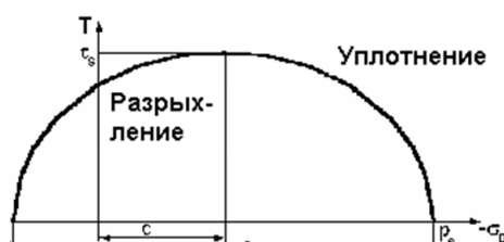
Рис. 2. Эллиптическое условие текучести порошкового материала в координатах T – интенсивность касательных напряжений, \sigma_0 – среднее (гидростатическое) напряжение.
