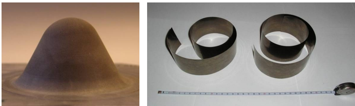
Рис. 9. Сверхпластическая формовка листа и тонкая фольга (размером 0.08 \times 120 \times 600 мм 3 ) из сплава Ti-23Al-23Nb-3(Zr,V,Mo,Si). Фольга изготовлена холодной прокаткой с промежуточными вакуумными отжигами.
