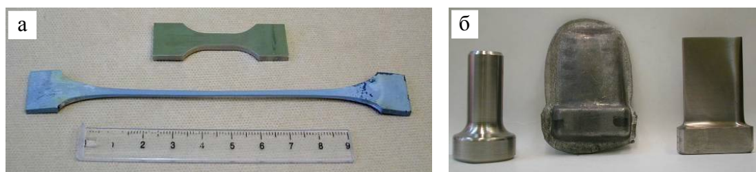
Рис. 6. (а) Образец сплава Ti-45Al-5Nb-1Mo-0.2B, растянутый в условиях сверхпластичности ( T=1000^\circ\text{C} , \delta=850\% , \sigma_B=95 МПа) и (б) лопатка, отштампованная в условиях сверхпластичности и подвергнутая финишной механической обработке.
