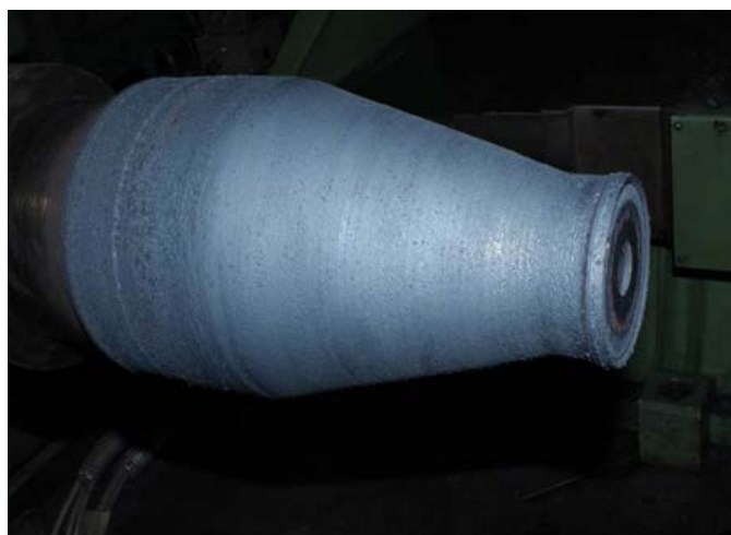
Рис. 5. Внешний вид раскатанного натурального вала из хромистой стали ЭИ962-Ш.
