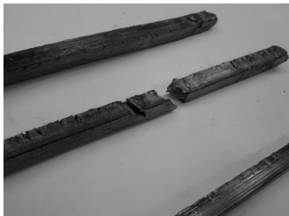
Рис. 7. Заготовки, полученные после четырех проходов РКУП-К.
