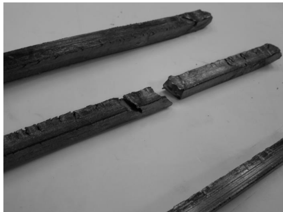
Рис. 7. Заготовки, полученные после четырех проходов РКУП-К.
