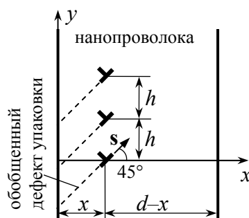
Рис. 2. Упрощенная модельная конфигурация дислокаций, используемая для расчета энергетических характеристик дислокационной системы.
